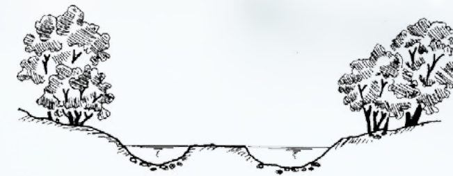
Arasement du banc jusqu'au niveau des basses eaux et enlèvement des matériaux
