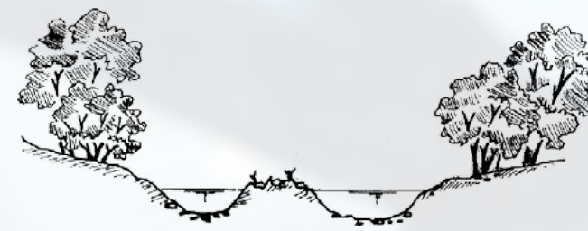
Retrait des végétaux et scarification de l'atterrissement
